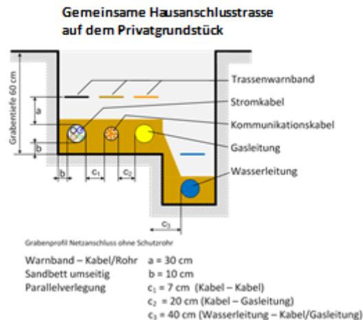
Die Kabel im Kabelgraben sind steinfrei einzusanden. Im Allgemeinen dürfen Kabeltrassen nicht überbaut werden (außer bei Kabelverlegung im Schutzrohr) und es dürfen keine tief wurzelnden Pflanzen vorhanden sein.
