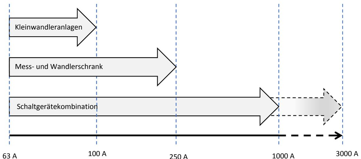
Zählerschrankkombinationen mit Zählerplätzen nach DIN VDE 0603-2-1 sind für Direktmessung bis max. 63A geeignet, darüber hinaus sind halbindirekte Messungen einzusetzen. Sofern eine Herstellererklärung für eine Niederspannungs-Schaltgerätekombinationen nach DIN EN 61439 (VDE 0660-600) vorliegt, sind auch Direktmessungen bis 100A möglich.
